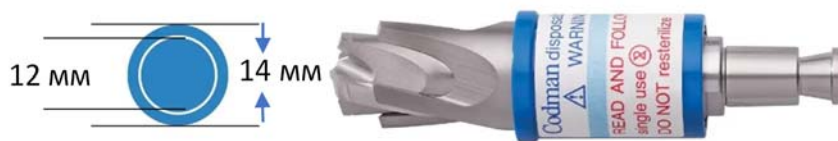
Рисунок 3 – Внутренний и внешний диаметр фрезы перфоратора «CODMAN»
